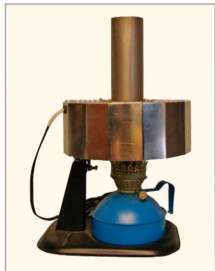
Рис.9. Действующая модель генератора на керосиновой лампе [7]
