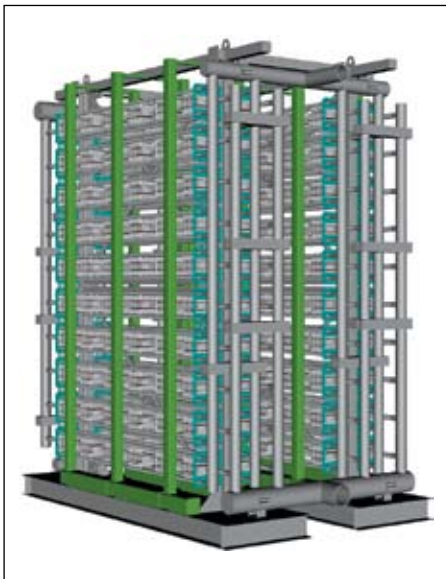
Рис. 7. Общий вид конструкции термоэлектрической системы с холодильной мощностью 20 кВт
