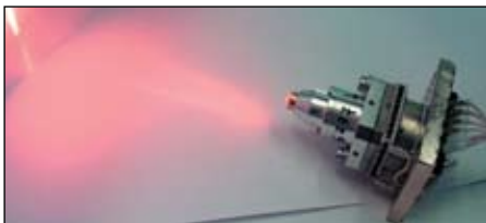
Рис. 12. Полупроводниковый лазер, установленный на термоэлектрическую охлаждающую сборку
