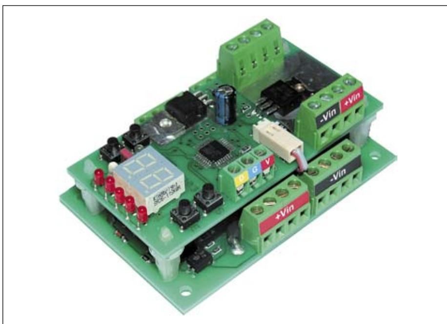
Рис. 20. Внешний вид регулятора температуры РТ103, установленного на реверсивный коммутатор KP101
