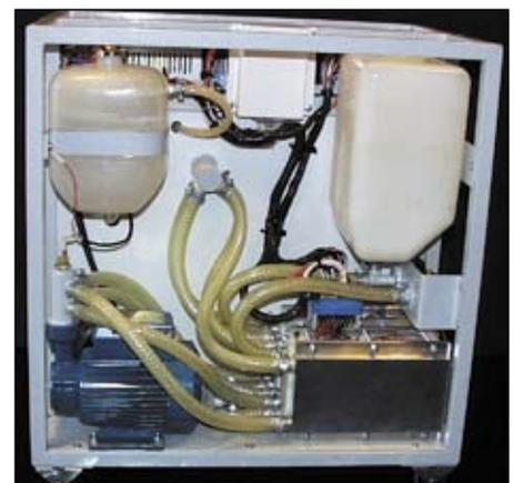
Рис. 17. Сборка типа «жидкость-жидкость» в составе чилера
