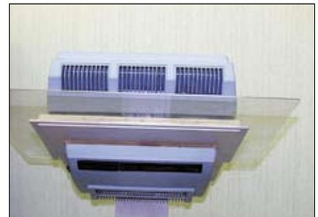
Рис. 16. Прототип ТЭС «воздух-воздух» в виде кондиционера
