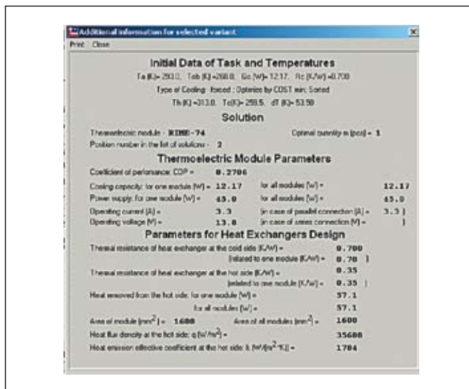
Рис. 28. Спецификация расчетных параметров TCOT
