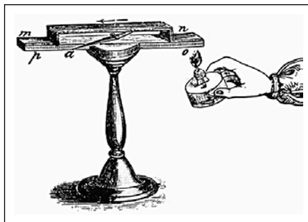
Рис. 2. Иллюстрация к опыту, демонстрирующему эффект Зеебека
